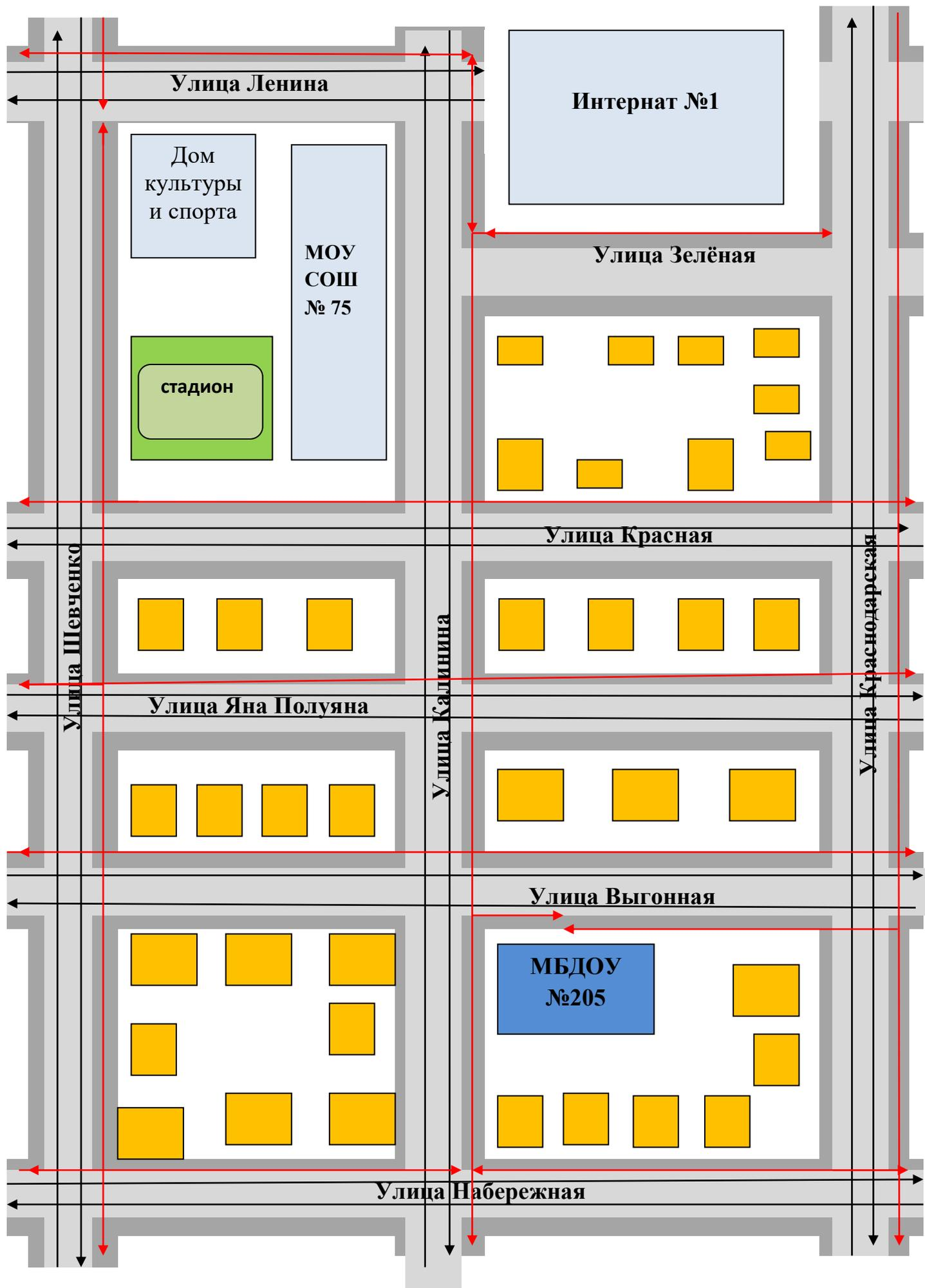
План-схема организации дорожного движения в непосредственной близости от МБДОУ №205 с размещением соответствующих технических средств, маршрутов движения детей и расположение парковых мест.
